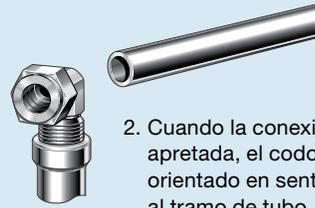
2. Cuando la conexión roscada está apretada, el codo macho queda orientado en sentido opuesto al tramo de tubo. Si se afloja la conexión roscada, ésta podría dar problemas de fugas.
