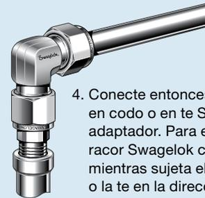
4. Conecte entonces una unión en codo o en te Swagelok al adaptador. Para ello, apriete el racor Swagelok con una llave, mientras sujeta el cuerpo del codo o la te en la dirección adecuada. Introduzca el tubo en el otro extremo del codo o la te, e instale el racor.
