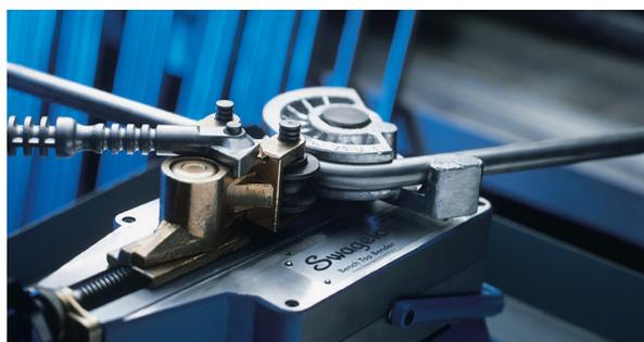
La dobladora de tubo de banco tiene una construcción robusta y ligera, que permite doblar de forma cómoda tubos de hasta 1 1/4” o 30 mm a ángulos entre 1 a 180°.
