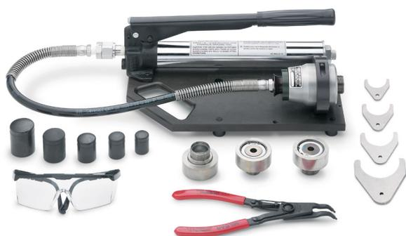
Esta herramienta permite deformar las férulas en el tubo antes de realizar la instalación final del racor. Esto reduce la fuerza a aplicar, por lo que facilita el montaje. Con la galga “no pasa” específica de la herramienta, se puede verificar que el racor está bien instalado. Tamaños de matriz disponibles de forma inmediata: 1”, 1 1/4”, 1 1/2” y 2”, 25mm, 28mm, 30 mm, 32 mm, y 38mm.
