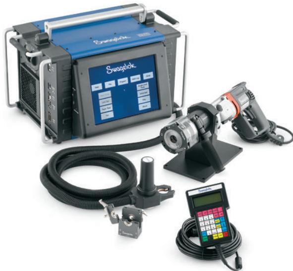
Este equipo realiza soldaduras automáticas, con un alto nivel de limpieza y sin aporte de material. El tubo se sujeta en el bloque de fijación y el electrodo gira alrededor del cabezal para soldar las piezas.
