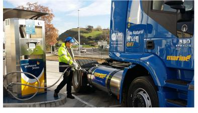
No obstante, este combustible ofrece ventajas adicionales: los motores de gas natural reducen hasta en un 50% la emisión sonora y las vibraciones respecto a un motor que use gasoil como combustible, alargando la vida útil del motor; asimismo los usuarios de este tipo de vehículos pueden disfrutar de diferentes subvenciones tanto de impuestos de circulación, como de aparcamientos y pejes de autopistas, dependiendo de los distintos municipios o comunidades por las que circulemos.
