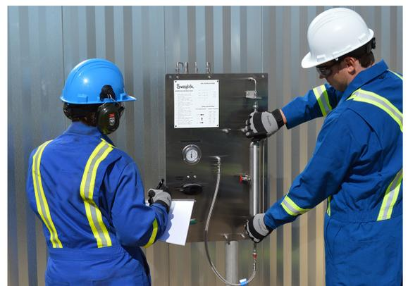
Para aplicaciones con fluidos tóxicos, existe la posibilidad de purgar la línea de llenado del Panel Toma de Muestra con el cilindro colocado. Esto permite purgar el volumen atrapado entre la válvula de cierre del cilindro y el enchufe rápido, eliminando así posibles residuos peligrosos que una vez terminada la toma podrían escapar durante el proceso de desconexión del cilindro provocando daños al personal y/o a la atmósfera.
